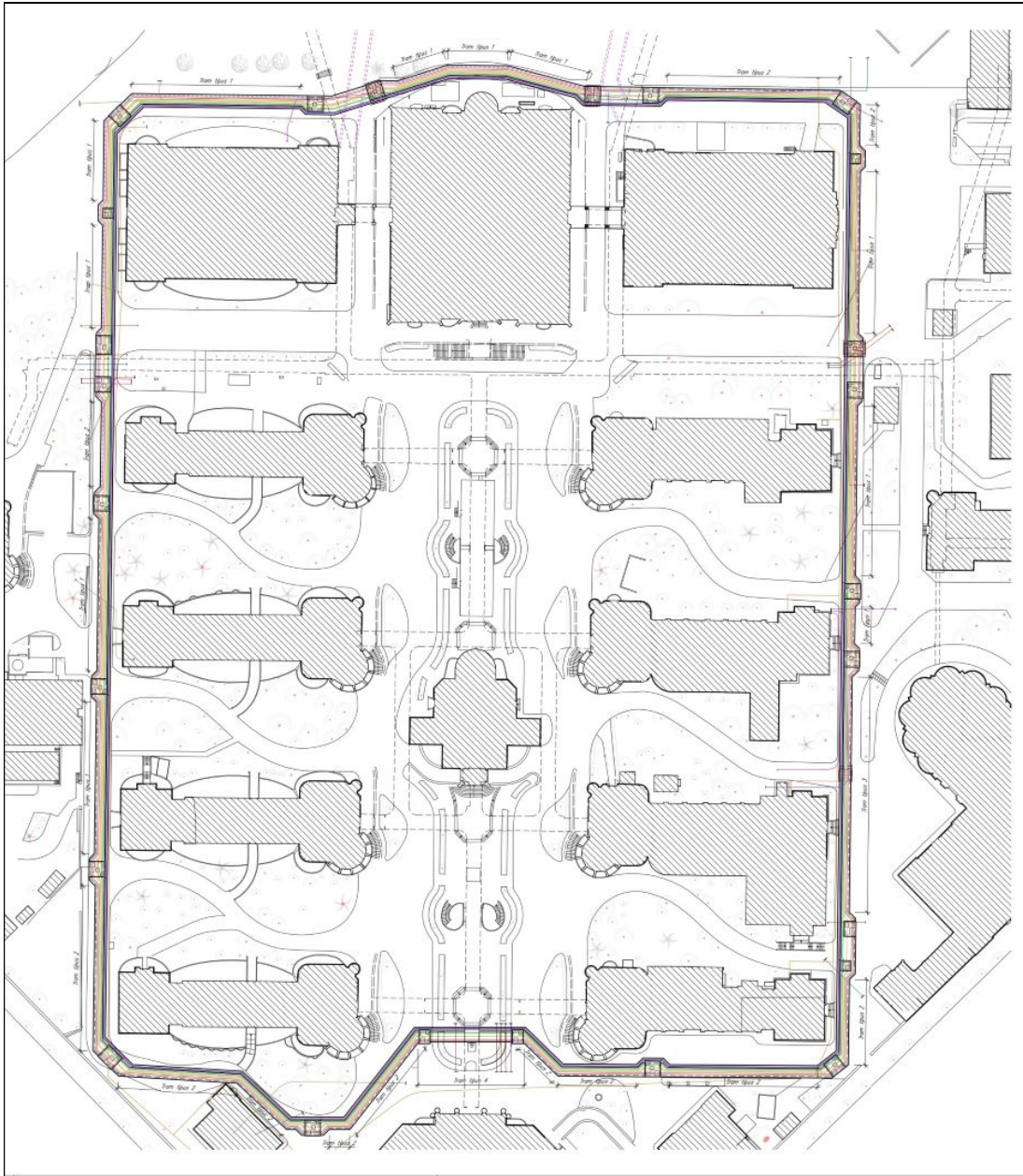
Prisma d'instal·lacions al voltant dels edificis històrics.
